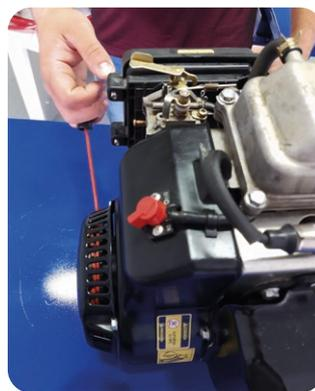
**ATENÇÃO:** Este primeiro movimento deve ser suave para o encaixe correto dos componentes demonstrados nas figuras a seguir. Uma vez que as hastes se abrem e encaixam nas paredes limitantes, se o movimento for brusco e não contínuo, o encaixe pode não ocorrer como deveria, fato que compromete as paredes internas deste sistema, e também diminui a vida útil da corda da partida retrátil.
